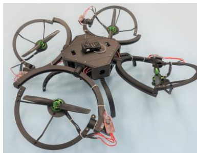
図 2 多軸推力方向可変 UAV
