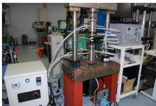
図3 高温疲労実験装置(本事業での設計開発)
