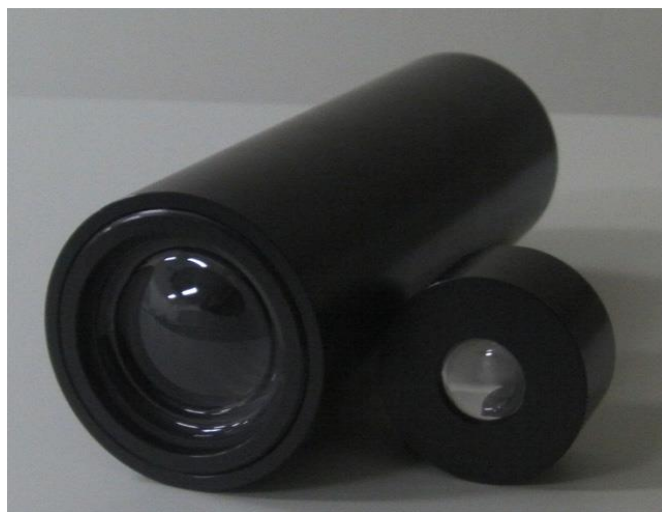
完成した広角中心窩望遠鏡対物レンズ+リレーレンズ部と特殊接眼レンズの写真
