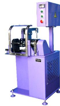
図②-3 一点荷重式 転動疲労試験機
