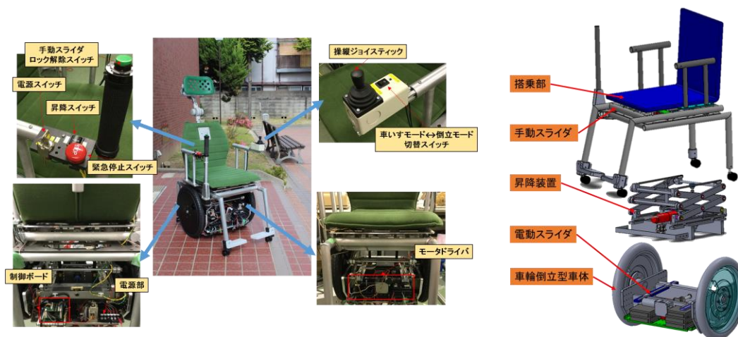
車輪倒立型電動車椅子の構造及び制御システムの構成
