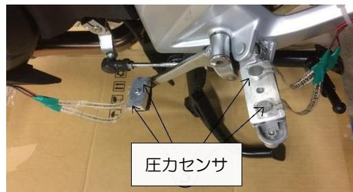
図6 圧力センサの配置
