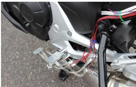
図5 ステップ部のセンサ
